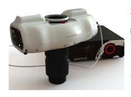
力传感器模块Lunam T-40i可同时测量多个光阱产生的力。本公司采用独特的专利技术测量激光束传播方向的次级振幅而非样品位置来得到力,测量更加直接。系统出厂时已进行过精确校准,样品造成的光束偏转与被捕获颗粒受到的力可以直接对应。
